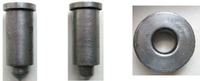
Рис. 9. Пуансон і матриця для відбортуння
